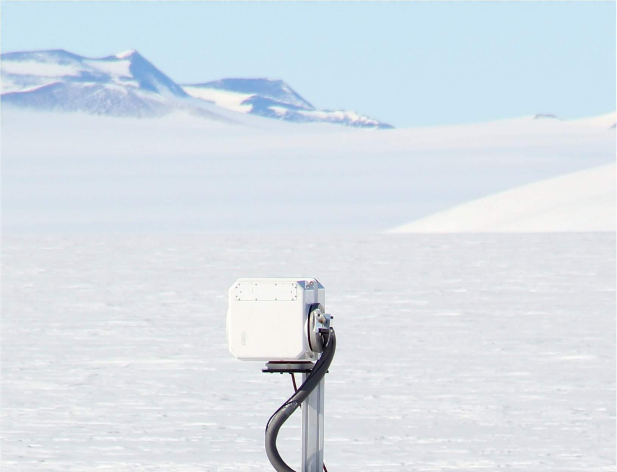
Mediciones de radiación solar UV en el campamento Glaciar Unión (Antártica). Estas mediciones permiten la determinación de la Columna Total de Ozono (TOC, por sus siglas en Inglés).
